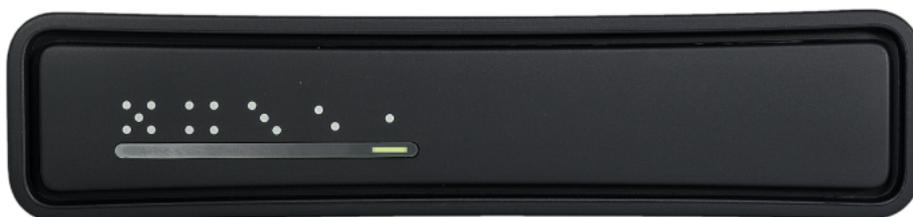
4. Der MikroTik WLAN-Router ist nun für Freischaltung und Einrichtung des Zugangs bereit. Optional ist ein LAN-Anschluss von weiteren Geräten an den Eingängen 2 bis 5 möglich. Sind diese Eingänge in Benutzung wird an der Vorderseite ebenfalls die jeweilige LED leuchten.
